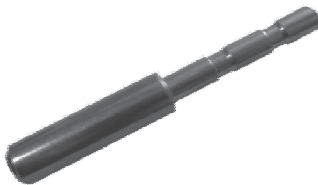
Πείρος για ενδοδαπέδιο στήριγμα ορθοστάτη Φ40 & 40X40 (μικρός πείρος - μήκος: 150mm, διάμετρος: 20mm) (Μόνο για κάγκελο με ύψος έως 400mm) Floor base pin for supporting mullion profiles Φ40 & 40X40 (short pin - length: 150mm, diameter: 20mm) (Only for railing with height up to 400mm)
