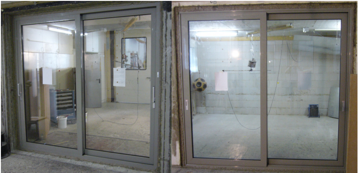
Bild 1 Fotos des eingebauten Elementes, links vom Empfangsraum aus, rechts vom Senderaum aus, erstellt vom ift Schallschutzzentrum
