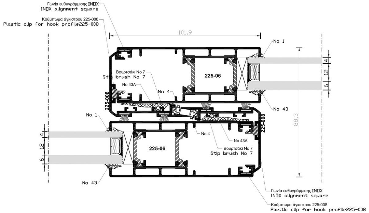
**Bild 2**      Horizontaler Querschnitt Mittelstoß
