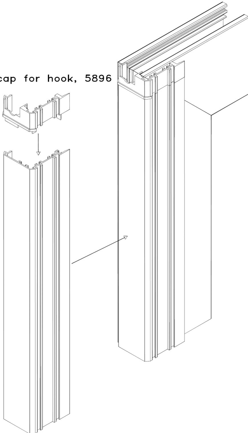
**Bild 4** Dichtprofile Mittelstoß oben / unten
