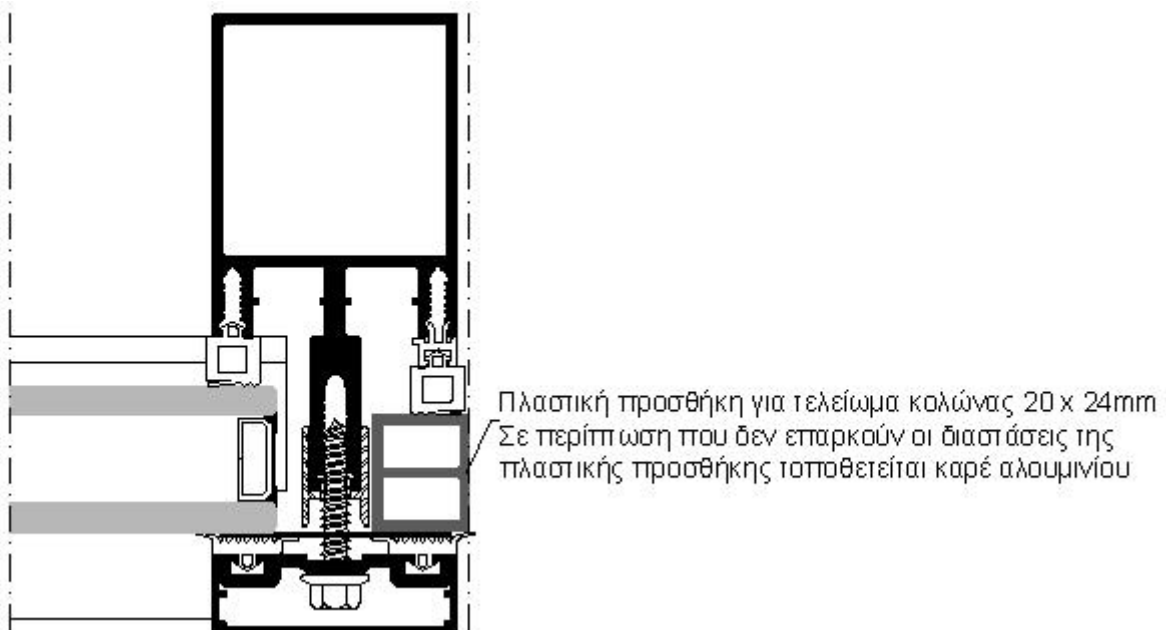
Εικόνα 35: Τελείωμα Albio 130 εξωτερικά τοποθετημένο
